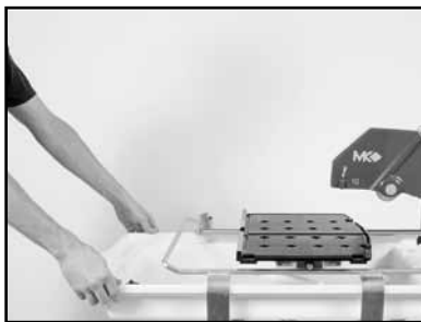
(D) Remove the Water Basin and clean.
